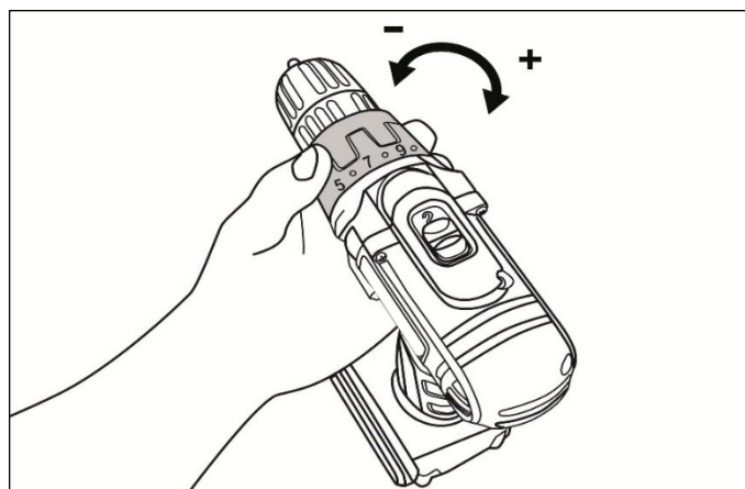
Рис. 10 Установка крутящего момента
